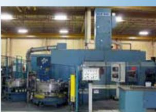
Ce tour monumental est une machine de tournage à broche verticale, (capacité d'usinage : Ø1300mm). Doté d'une double palette qui nous permettra d'optimiser nos productions en temps masqués et de réaliser les objectifs de production suivants :
