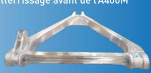
Cette pièce est réalisée dans une forge en aluminium de 260 kgs pour un poids de 55 kgs une fois usinée. D'une taille de 1,400 X 1,100 mètres, cette pièce de grande dimension est réalisée sur la DMU210 de Sommières pour notre client Safran Landing System (site de BIDOS).
